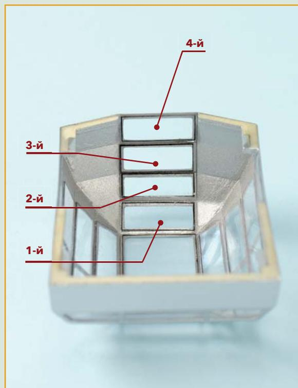
**17** Завершите изготовление остекления, приклеив «стекла» к остальным трем сторонам кабины в той же последовательности, снизу вверх.
